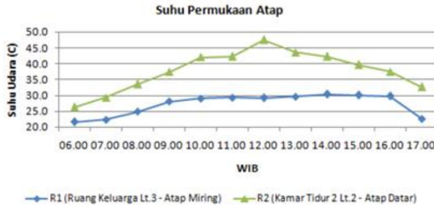
Gambar 5. Grafik hasil pengukuran suhu pada permukaan atap
