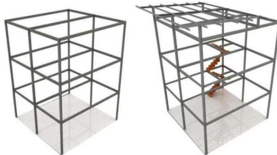
Gambar 13. Sistem struktur rangka secara keseluruhan pada objek kajian dengan baja WF 150 x 75 mm (Sumber: Penulis, 2022)
