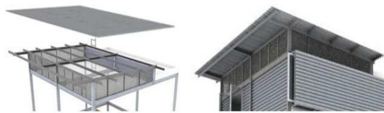
Gambar 11. Atap miring satu arah (timur lebih tinggi) berupa lembaran metal gelombang yang diletakkan berjarak +/- 60 cm dari batas dinding, sebagai ventilasi udara. (Sumber: Penulis, 2022)
