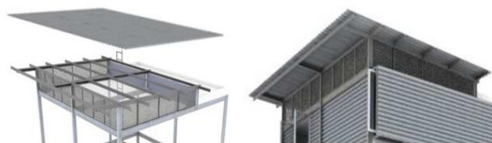
Gambar 11. Atap miring satu arah (timur lebih tinggi) berupa lembaran metal gelombang yang diletakkan berjarak +/- 60 cm dari batas dinding, sebagai ventilasi udara.
