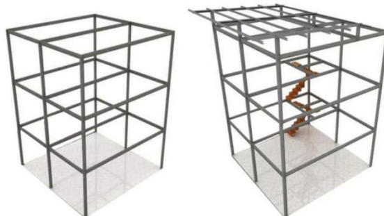
Gambar 13. Sistem struktur rangka secara keseluruhan pada objek kajian dengan baja WF 150 x 75 mm Sumber: Penulis, 2022
