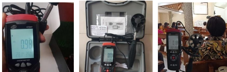
Gambar 2. Anemometer Benetech GT8907 (Sumber: dokumentasi penulis, 2022)
