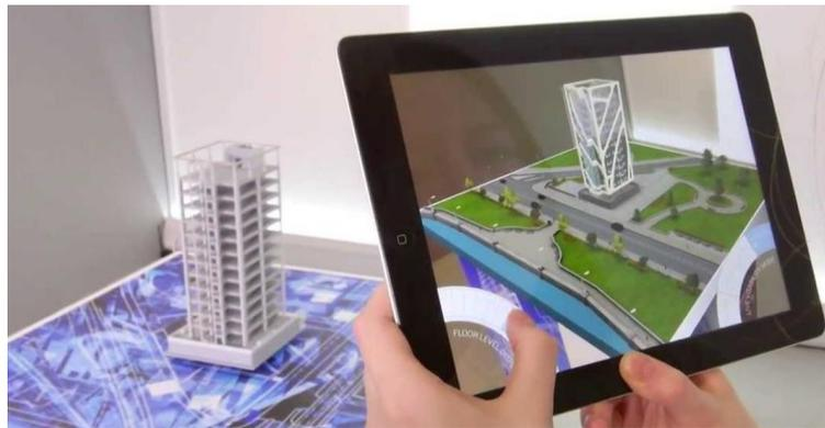
**Gambar 3. Perangkat AR Dalam Melihat Desain Arsitektur Secara Virtual Tiga Dimensional**
