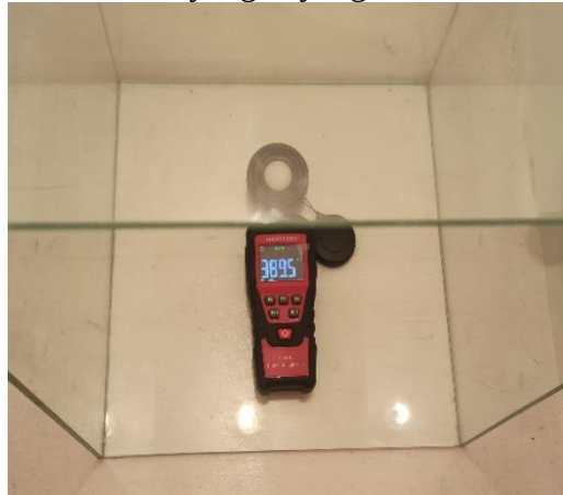
Gambar 9. Proses Pengujian Pencahayaan Alami
