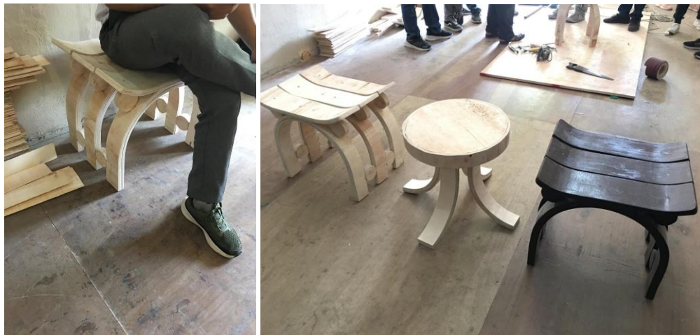
Gambar 4. Hasil akhir produksi furniture teknik bending triplek
